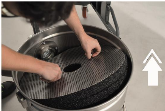
6. Odstraňte další dva látkové filtry díky dvěma úchytkám
