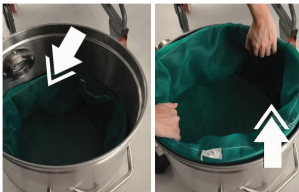
7. Vyměňte síťový koš a PPL filtr z oleje
