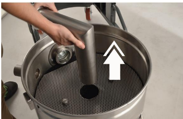
5. Vyměňte vnitřní potrubí z filtrů
