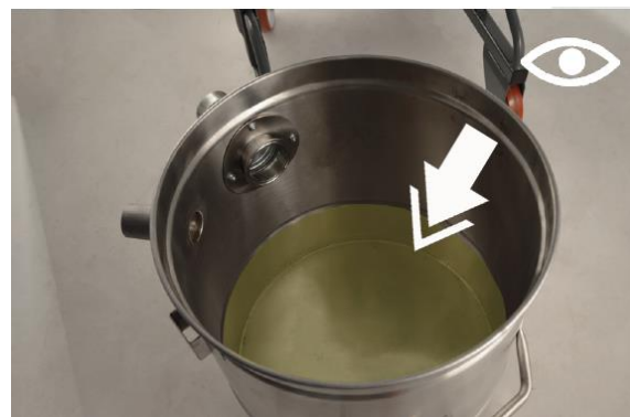
8. Zkontrolujte, zda je olej čistý a dá se znovu použít
