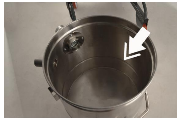
10. Pokud olej vypouštíte úplně, naplňte nový olej dle indikátoru uvnitř kontejneru.
